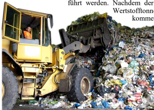
Wertstofftonne in Untitz angekommen ist, gibt ein Radlader das Sammelgut in den so genannten Sackaufschlitzer ein. Hier werden als erstes die Kunststofftüten und -säcke aufgeschlitzt. So kann sich der Inhalt gut auf dem Sortierband verteilen.
