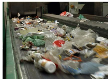
Nachdem die Maschinen die Abfälle bestmöglich sortiert haben, erfolgt zum Schluss noch eine händische Kontrolle. Die Hände der Mitarbeiter huschen über das Sortierband und sortieren die Fremdmaterialien heraus, welche die Maschinen übersehen haben.
