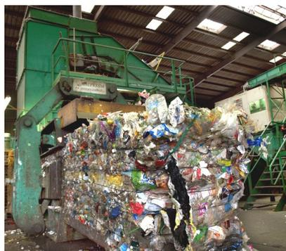
Die einzelnen Materialarten werden dann zu Ballen gepresst und gehen zur Verwertung. So entsteht unter anderem aus Joghurtbechern ein Granulat. Dieses wird dann zum Beispiel für die Herstellung eines Eimers eingesetzt. Aus dem Getränkekarton wird wiederum Wellpappenrohmaterial für entsprechende Verpackungen dient.
