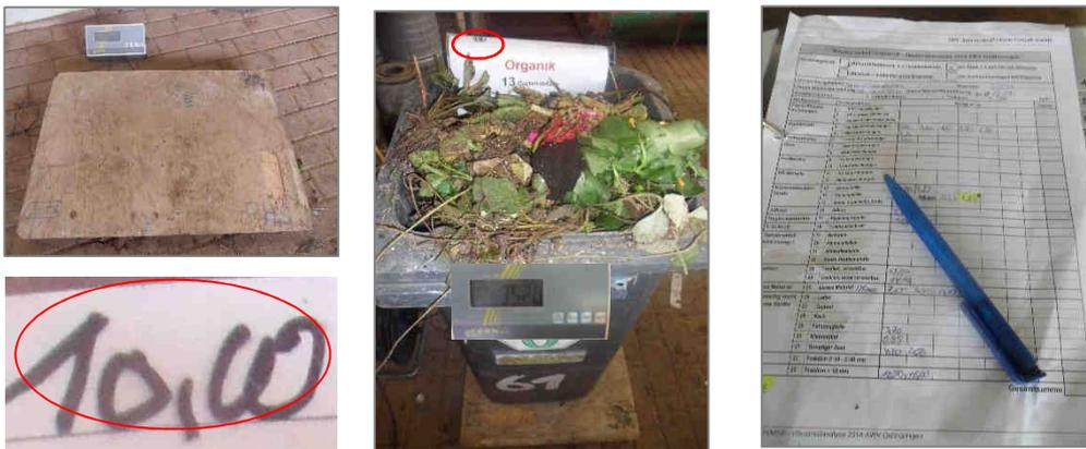
**Foto 15: Gartenabfallverwiegung mittels Bodenwaage und Protokollierung der Wägeergebnisse**
