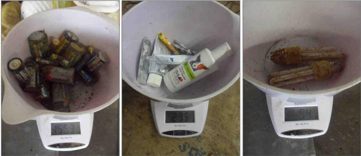
Foto 17: Wägung leichter Sortierfraktionen mittels Haushaltswaage (Toleranz  $\leq 0,001$  kg)
