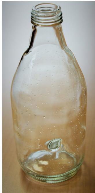
Einschlüsse, die durch Fremdstoffe entstehen, führen zum Qualitätsverlust
